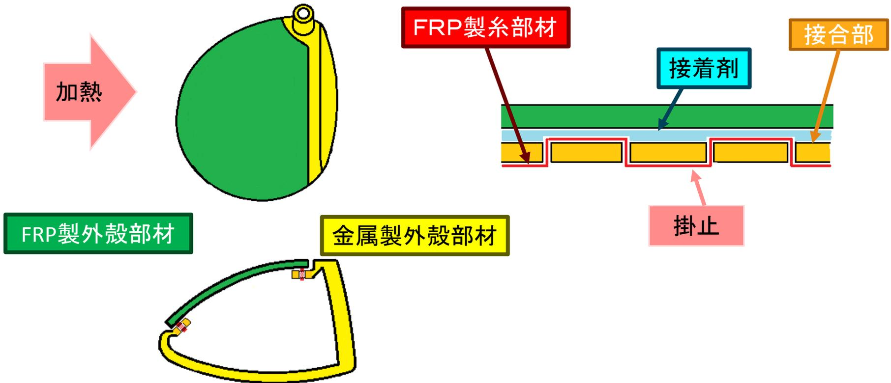
接着剤によりそれぞれの接合部でFRP製外殻部材を金属製外殻部材に接着した後に両接合部に適宜圧力を加えながらヘッド本体を加熱すると、糸部材のエポキシ樹脂がFRP製外殻部材のエポキシ樹脂と一体的に硬化し、外面において糸部材はFRP製外殻部材に対して強く接着される。【0013】
